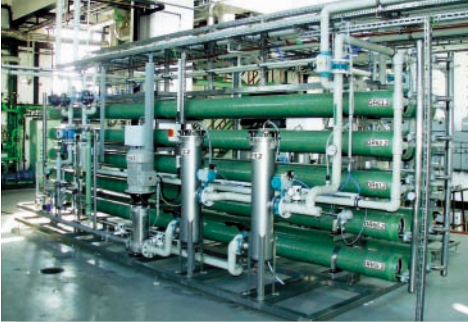
3: Die Spiralwickелеlemente der Umkehrosmoseeinheit halten bereits bei niedrigen Arbeitsdrücken große Mengen Salz zurück
